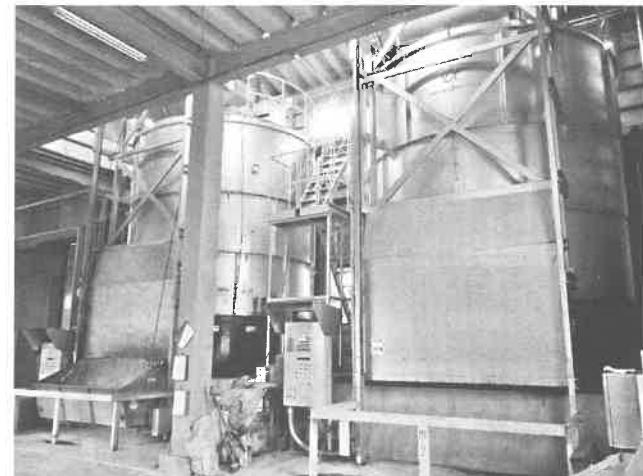
稼働中の縦型発酵槽。槽内や製品の取り出し口から出る臭気はダクトで吸引し、屋外の微生物脱臭槽で処理する。この脱臭システムに加え、発酵状態を良好に保つことで、臭気トラブルの発生を抑えているという
